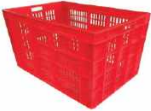
Capacity : 45 ltrs OD : 600(L) x 400(B) x 225(H) mm ID : 565(L) x 365(B) x 220(H) mm
